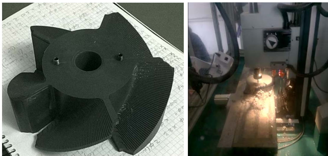
Figura 3: Imágenes del maquinado de la Turbina Kaplan en el Colegio Cristo Obrero, 2017
