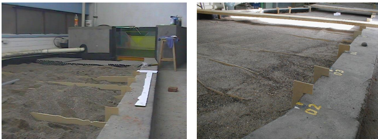
Fig. 2 Construcción de una maqueta –modelo de tramo urbano del Río Percey en Trevelin
