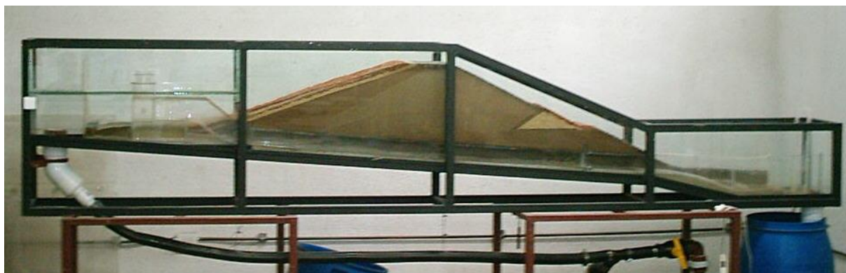
Fig. 3: Vista de Maqueta-Modelo Presa Cuenco Aluvional III , Puerto Madryn
