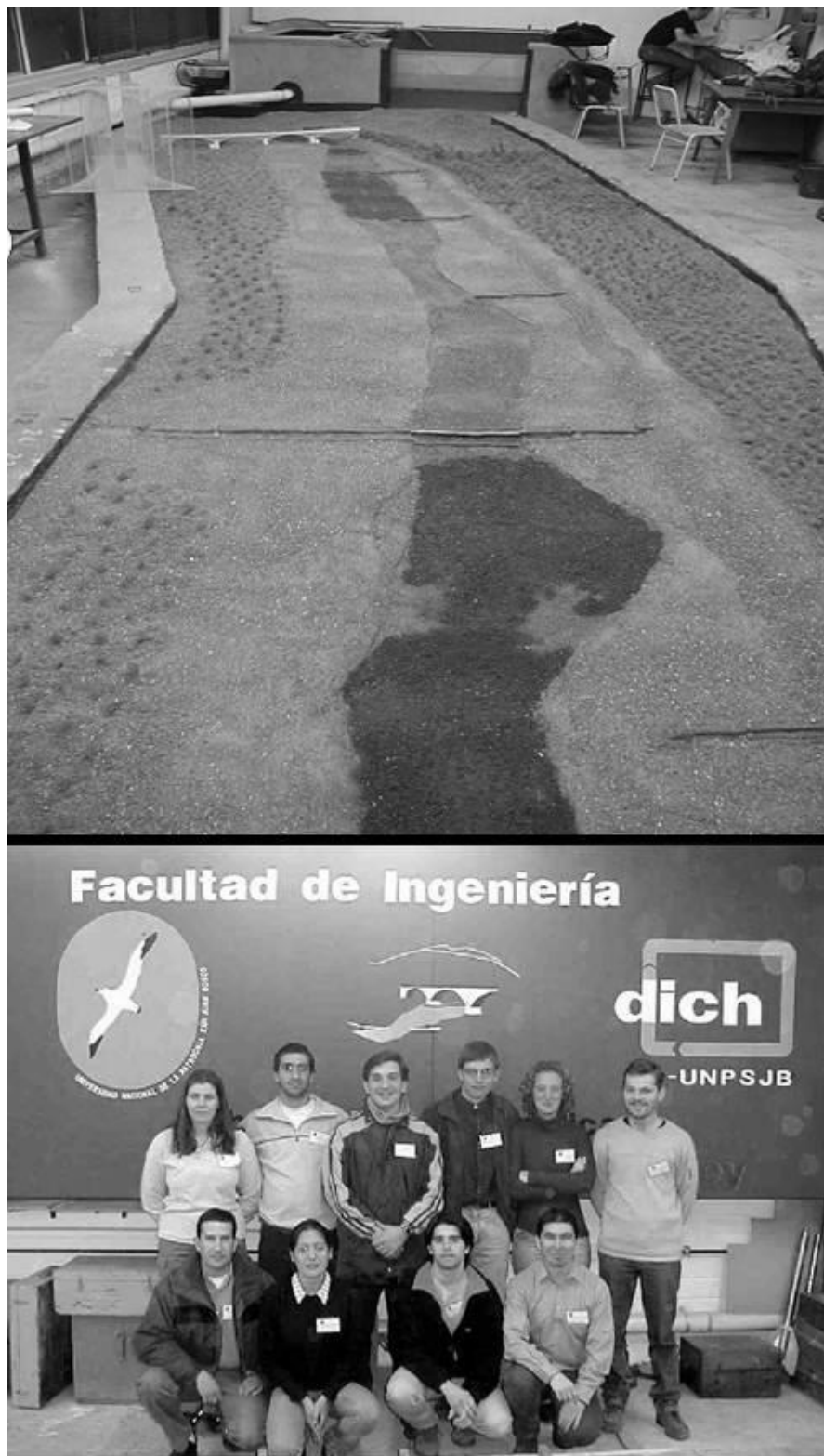
Fig. 5: Construcción del modelo físico de fondo móvil: ensayo de prueba – equipo de trabajo
